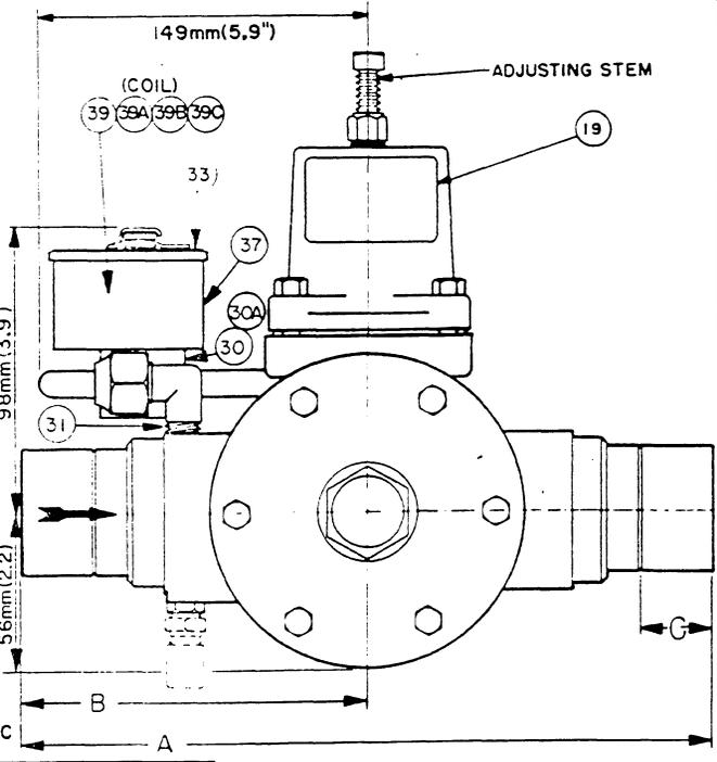
A72S WITH PILOT ELECTRIC SHUTOFF
